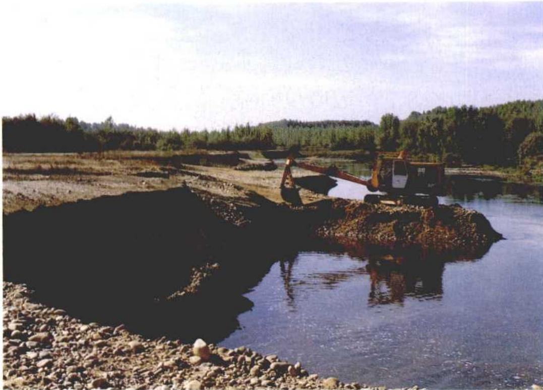
FOTO 4.3.4.3. Explotación C6. La grava se extrae hasta una profundidad de un metro por debajo del nivel del agua.
