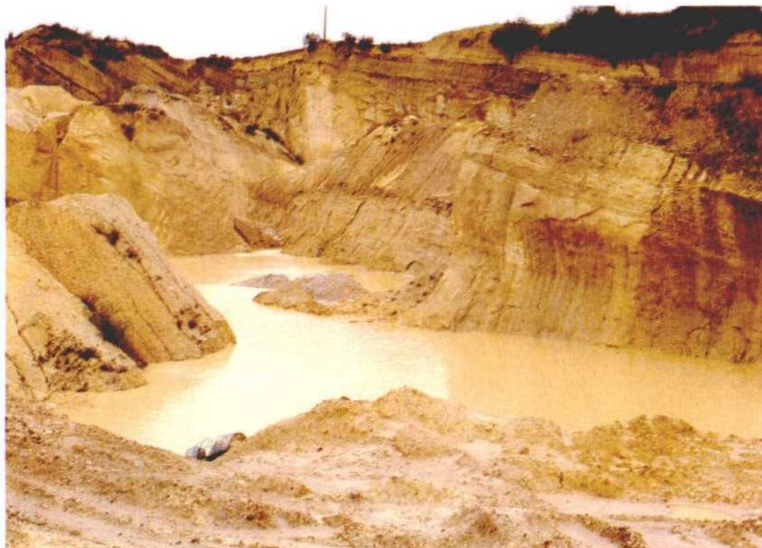
FOTO 5.1.4.1. Los movimientos de tierra asociados a las explotaciones de canteras ocasionan cambios considerables en la morfología fluvial y terrestre, así como graves problemas de erosión.
