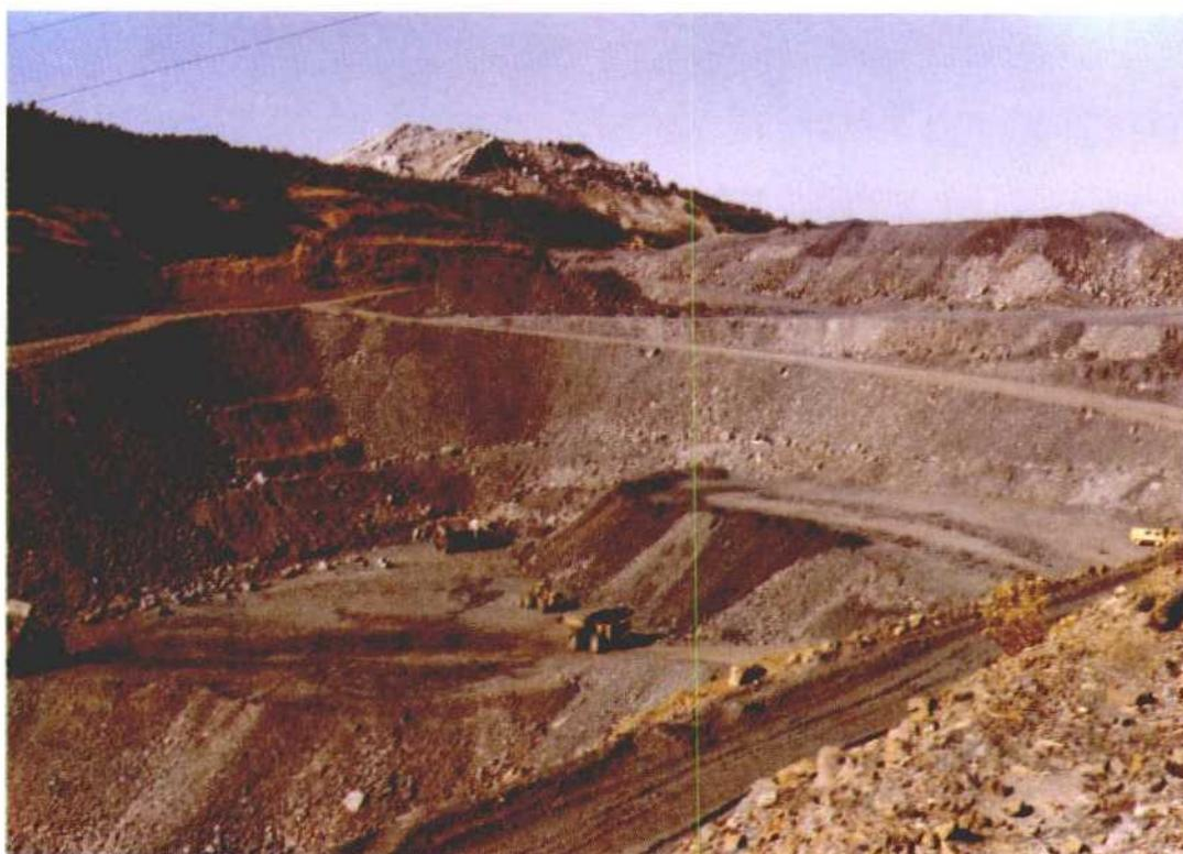
FOTO 4.1.3. Transferencia de estériles al hueco en la explotación E2.
